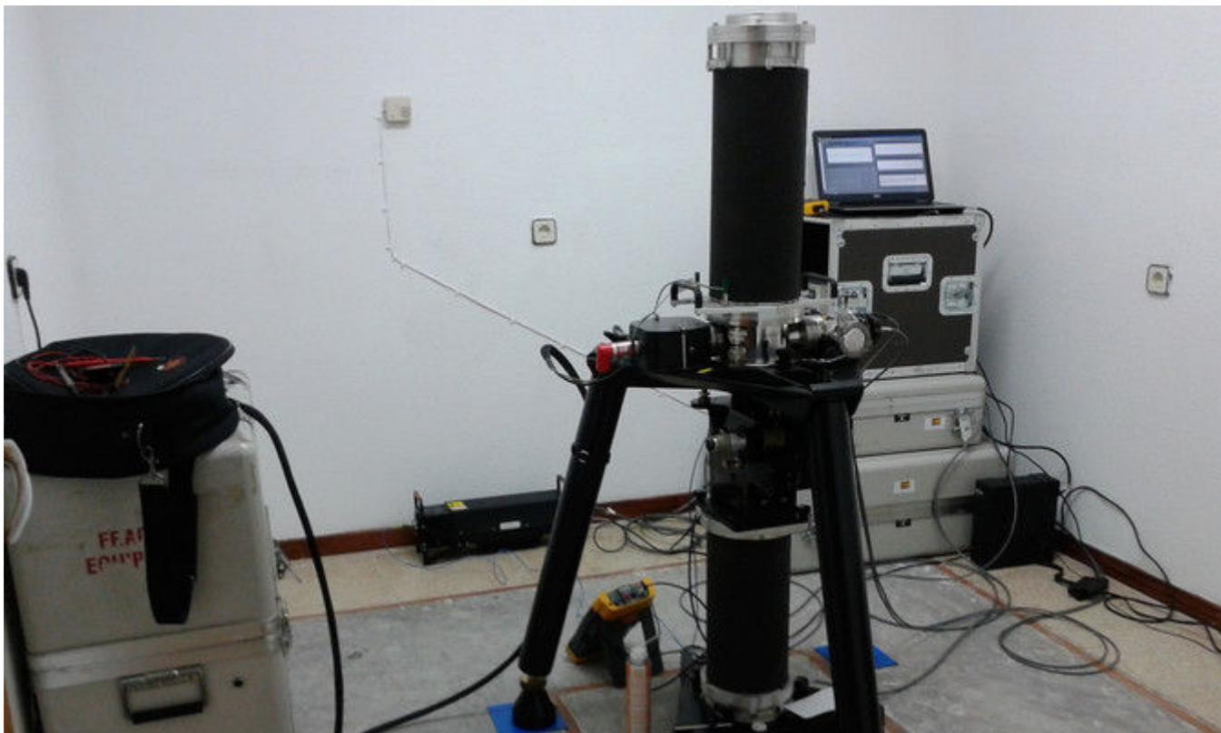
Gravímetro Absoluto FG-5 del IGN midiendo en la estación absoluta de la gravedad. / IGEO
